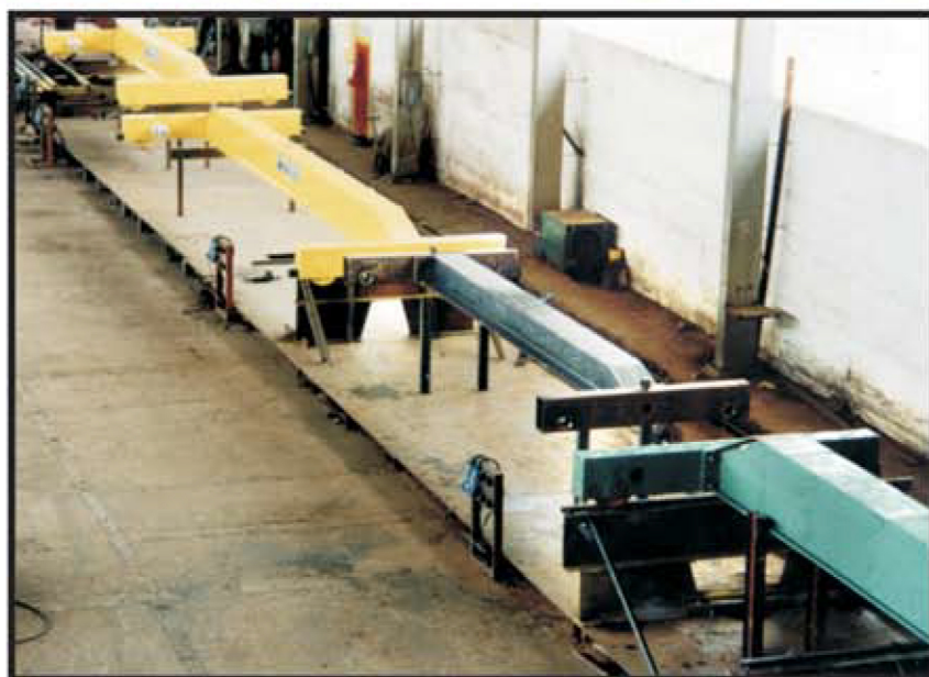
Linha de montagem de Pontes Rolantes tipo monoviga (Pátio FERRAL)
