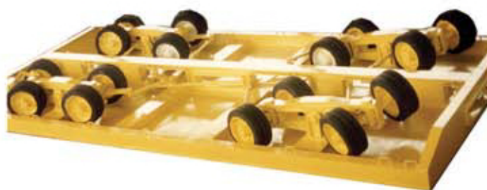
Carreta de transporte de transformadores capacidade 20 toneladas, sistema multi-direcional, suspensão tipo triaxial e freios mola com acionamento hidráulico. cliente: PETROMISA
